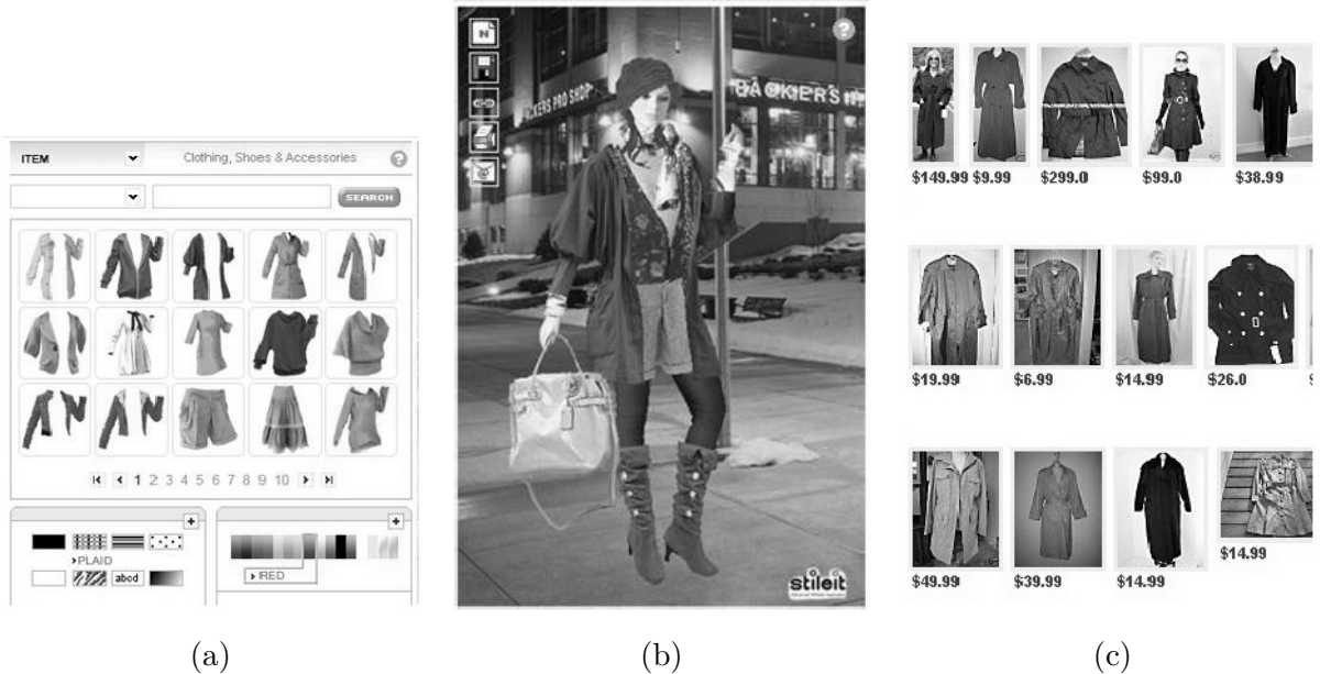
그림 4. 논문에서 사용한 시물레이션을 이용한 이미지 속성 검색 모습. (a)는 주어진 다양한 형태의 옷 형태를 바탕으로 색상과 질감을 바꿀 수 있으며 이것으로 이미지 검색을 시도한다. (b) (a)를 선택했을 때 가상의 캐릭터에 옷 정보를 시물레이션 한 모습. 캐릭터가 입은 모습을 보면서 실제 착용 모습을 연상할 수 있다. (c) (a)로 검색한 이미지의 실제모습. 이미지들은 이베이 사이트에 올라온 실제 이미지로 사용자가 검색한 이미지와 유사한 것으로 여겨지는 이미지들을 나타내었다.
